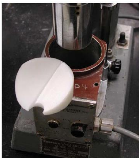
Рис.1. Общий вид и схема термостакана вискозиметра и накопительной вставки sag shoe.
